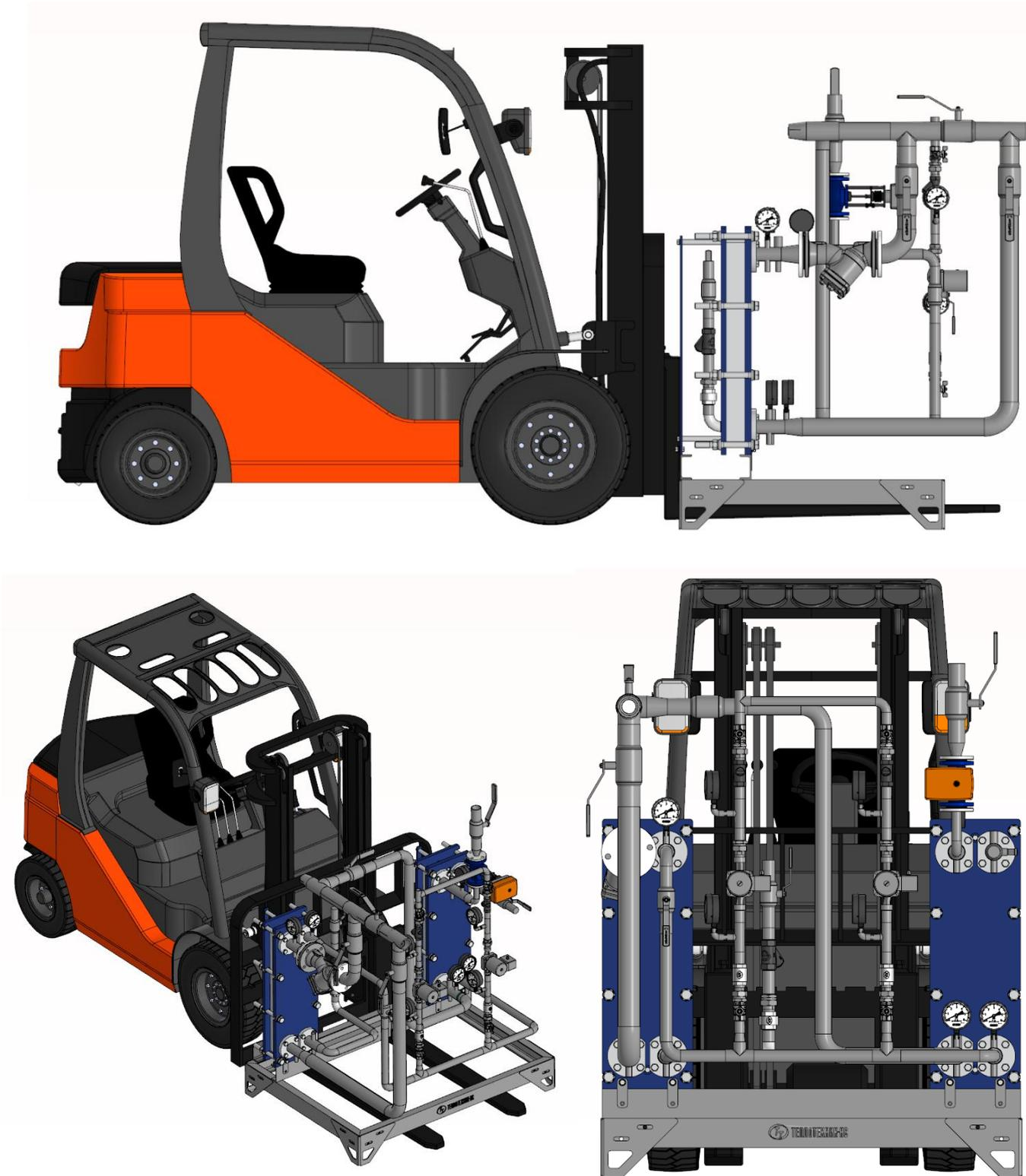
Рисунок – 7. Схема транспортировки блока с помощью вилочного погрузчика
