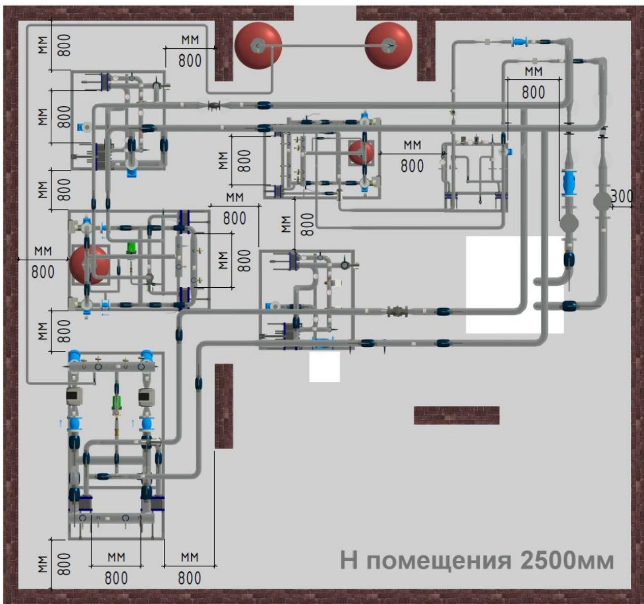
Рисунок – 11. Проектный план расстановки блоков
