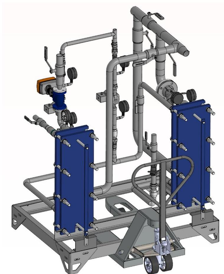
Рисунок – 6. Схема транспортировки блока с помощью вилочной тележки
